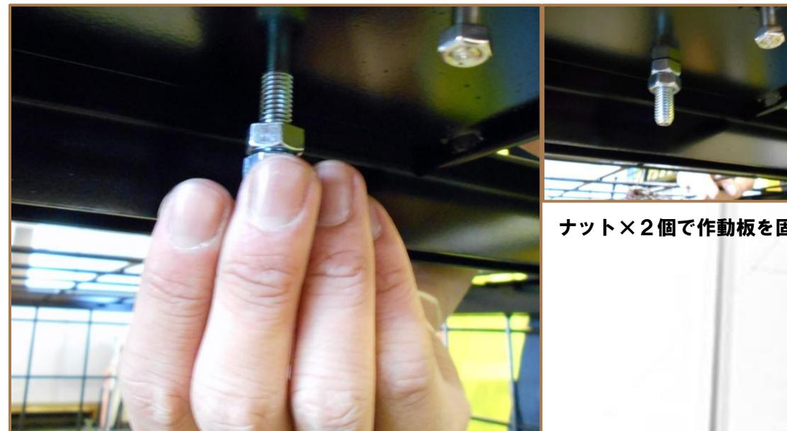
ナット×2個で作動板を固定します。
