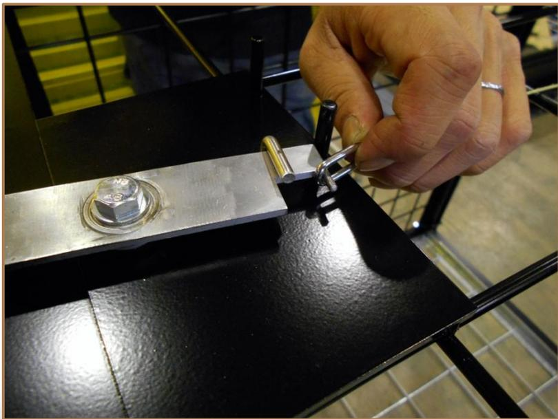
5. 作動板の先端に仕掛け棒のOリングを引っ掛けます。
