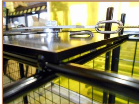
※作動板と安全装置が干渉していないか確認をしてください。
