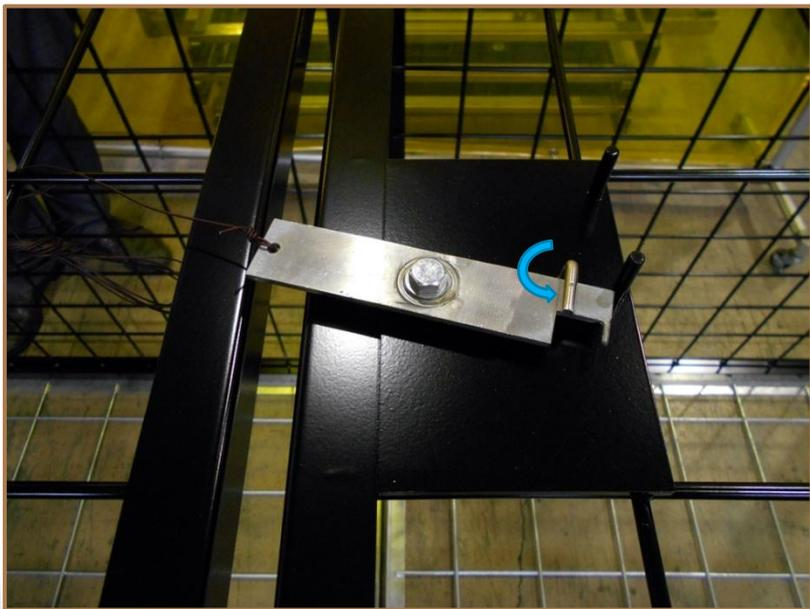
1. 仕掛けの安全装置を回転させ、作動板を固定します。
